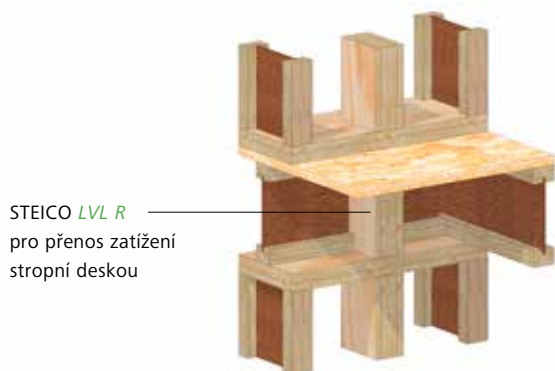
F5 Přenos vysokých bodových zatížení stropní deskou
