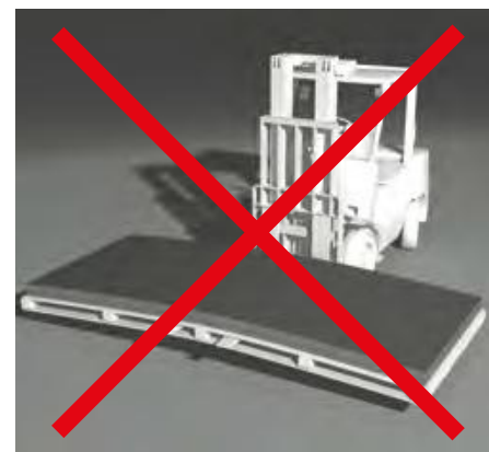
Nesprávná přeprava vysokozdvíhacím vozíkem Obrázek 45
